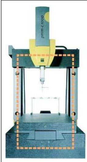
Cette structure en portique et ses variantes, en particulier le portique fixe montré en Figure, ont démontré une réelle capacité à constituer des machines efficaces et de haut niveau métrologique grâce à la rigidité et à la stabilité du cadre fermé ou de la poussée centrale proposée par Zeiss. Cette structure est essentiellement celle des laboratoires de métrologie mécaniques.
