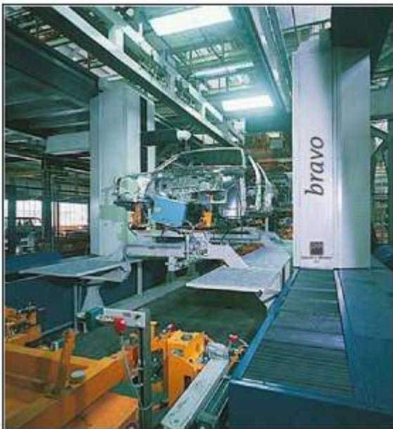
Les machines à bras sortant sont très courantes dans l'industrie automobile en métrologie des carrosseries. La structure de ces machines est très ouverte et ressemble à celle des colonnes de mesure en métrologie au marbre. Sur l'image de droite de la Figure, on se rend compte des volumes utiles possibles.
