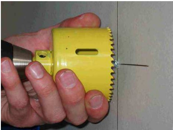
3. Centrage du foret sur le traçage
