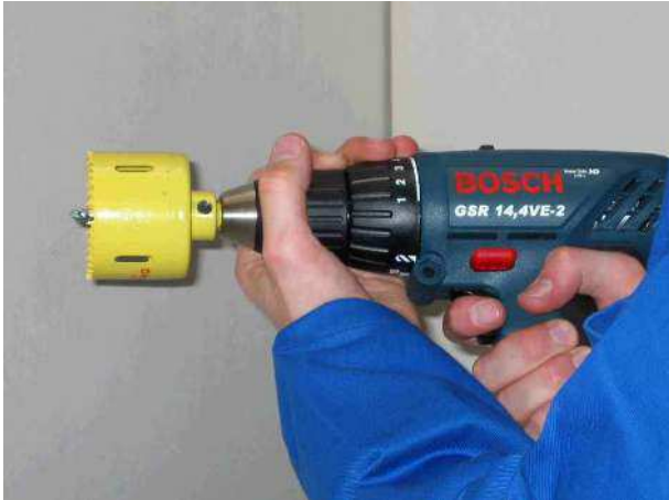
1. Montage de la scie cloche (dépassement de 1 cm du foret de centrage )
