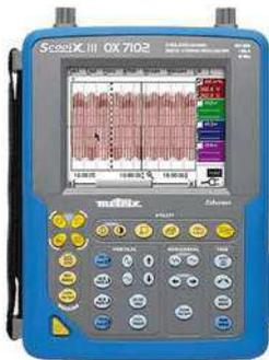
**Visualiser** un signal électrique en fonction du temps.
