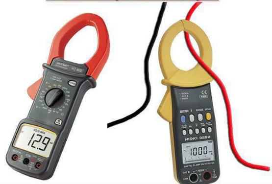
Mesurer des grandeurs électriques (Tension, courant, résistance,...) pratique pour la mesure du courant avec sa pince on entoure simplement le conducteur à mesurer.
