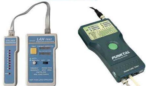
**Contrôler** le fonctionnement d'un câble réseau, cordon Ethernet, RJ45, RJ11, BNC ...
